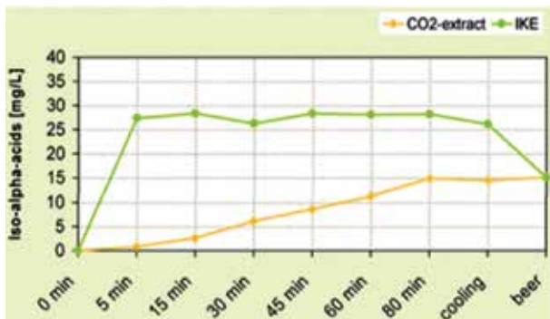
Hình 3: phân tích sự thay đổi của nồng độ iso-alpha-acid từ khi đun sôi dịch đường đến bia được đóng chai.
