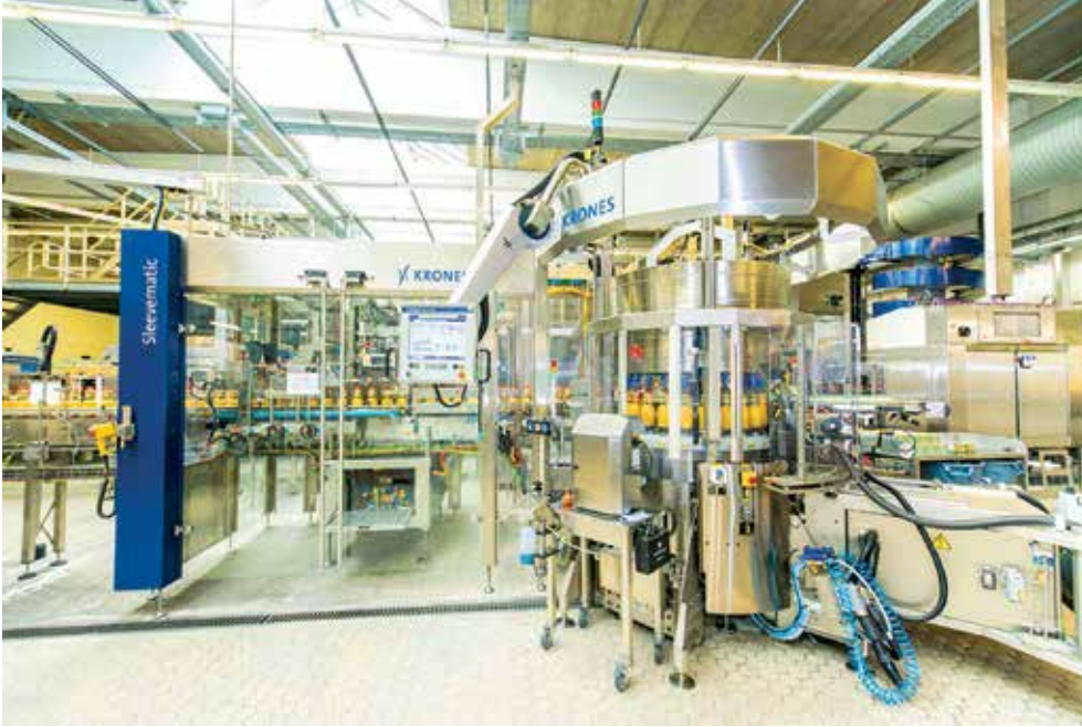
Dây chuyền bao gồm Máy dán nhãn đa năng kết hợp đồng bộ với hệ trông nhãn và hầm co nhiệt: có thể dán được tất cả các loại nhãn bao gồm nhãn quấn tròn (wrap-around), nhãn tự dính (pressure-sensitive labels) và nhãn ôm chai (sleeves).
