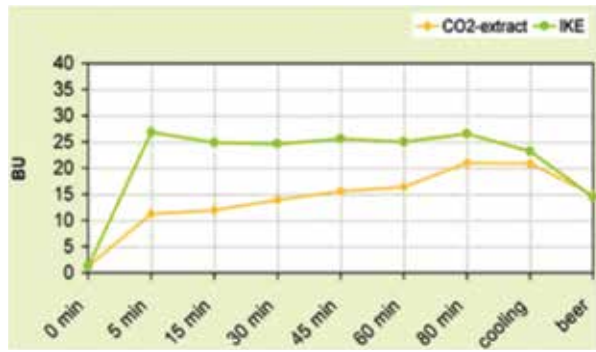
Hình 4: Phân tích độ đắng (BU) từ khi đun sôi dịch đường đến bia được đóng chai
