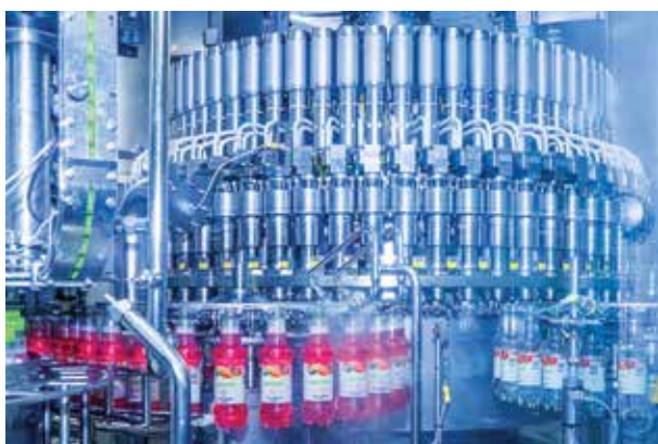
Máy chiết Modulfill VFS mới với van chiết PFR đảm bảo chiết rót nhẹ nhàng và không bị trào bọt cho chai PET.
