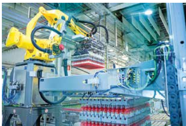
Cụm Robotgrip thứ hai gấp 96 chai và đặt chúng vào các khay được đặt sẵn trên pallet.
