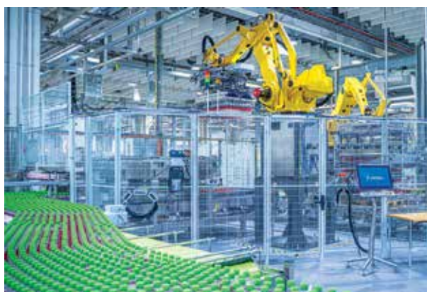
Đóng thùng và xếp pallet là hai bước cuối của quy trình. Hai cụm Robotgrip cùng nhau hoàn thành việc này
