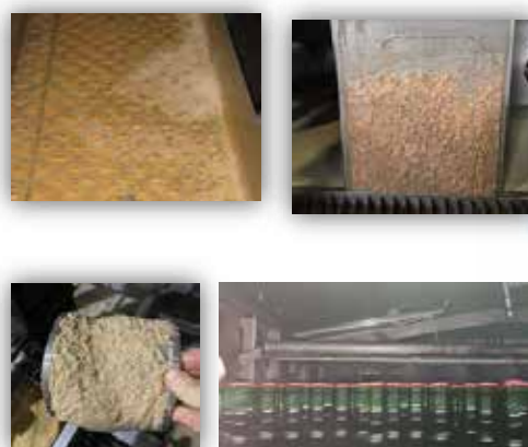
Hình 3. Các cấu cặn và biofilm trong hầm thanh trùng
