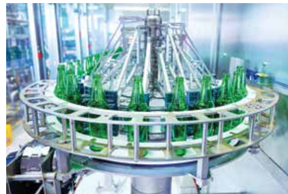
Bánh sao với công nghệ động cơ tuyến tính hiện đang được thử nghiệm tại nhà máy sản xuất.
