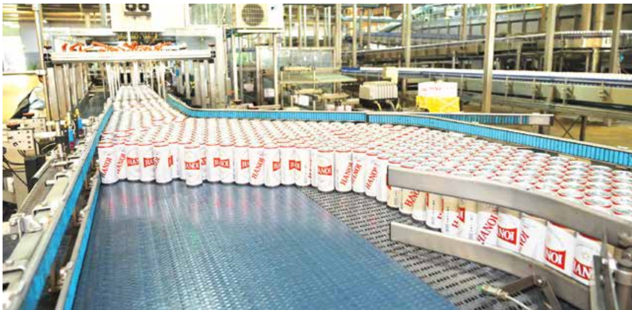
Dây chuyền chiết lon hiện đại của Nhà máy Bia Hà Nội - Mê Linh.
